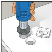
4. Aussparungen für Schalter und Steckdosen vor der Platten-Montage mit einer Lochsäge o.Ä. bohren und geeignete Unterputzdosen verwenden.
