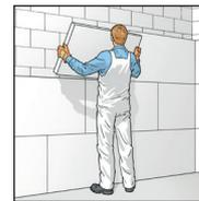
6. Klimaplatten übereinander versetzt (mind. 20 cm) mit mäßigem Druck an die Wand anpressen. Kreuzfugen und Lücken vermeiden. Überschüssigen Kleber an den Rändern entfernen.
